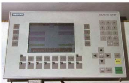
La máquina es operada a través de seis estaciones de trabajo, cada una con su OP27.
