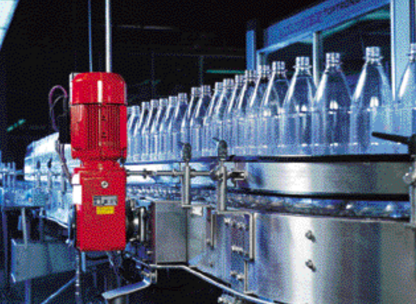
Accionamientos COMBIMASTERtransportan las botellas en la sección de llenado.
