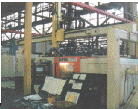
Arriba: torno MONFORTS con robot de carga y descarga Abajo: conjunto de mecanizado y carga de piezas
